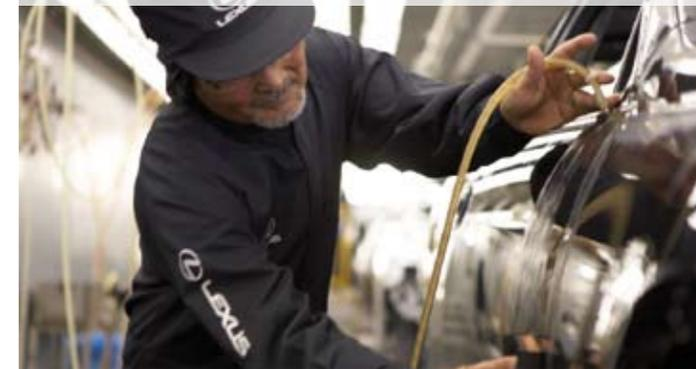
Lexus se pulen con agua mediante una lijadora tras la aplicación de cada capa de base, y se examinan de forma visual y digital para asegurar una calidad percibida óptima. Posteriormente, se pule con agua y a mano toda la capa de base, antes de aplicar la última capa transparente, para garantizar así una calidad de acabado inigualable tanto física como visualmente.
