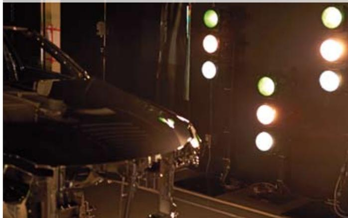
Además, se crearon una serie de datos digitales sobre el historial cromático de cada pieza, que se emplean para supervisar y controlar numéricamente el color de cada componente. Para eliminar las diferencias de color, se aplica el mismo acabado de base a las piezas fabricadas con materiales distintos, como el frontal y el parachoques, y sólo se ensamblan las piezas que coinciden exactamente con el color digitalizado especificado.
